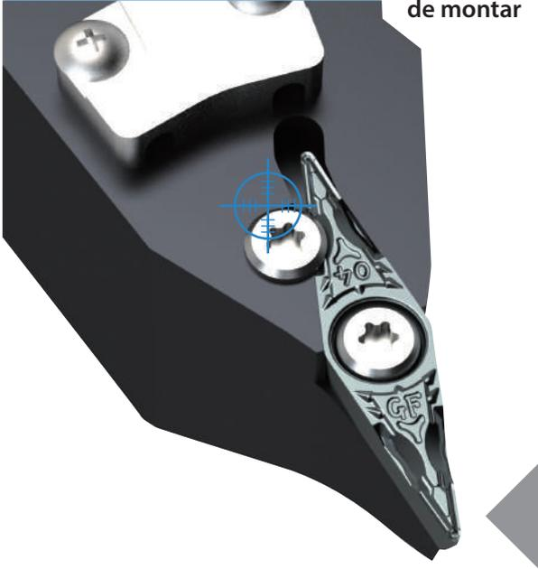
Las indentaciones para la sujeción del tornillo están diseñadas en el cuerpo de la pieza de inserción
