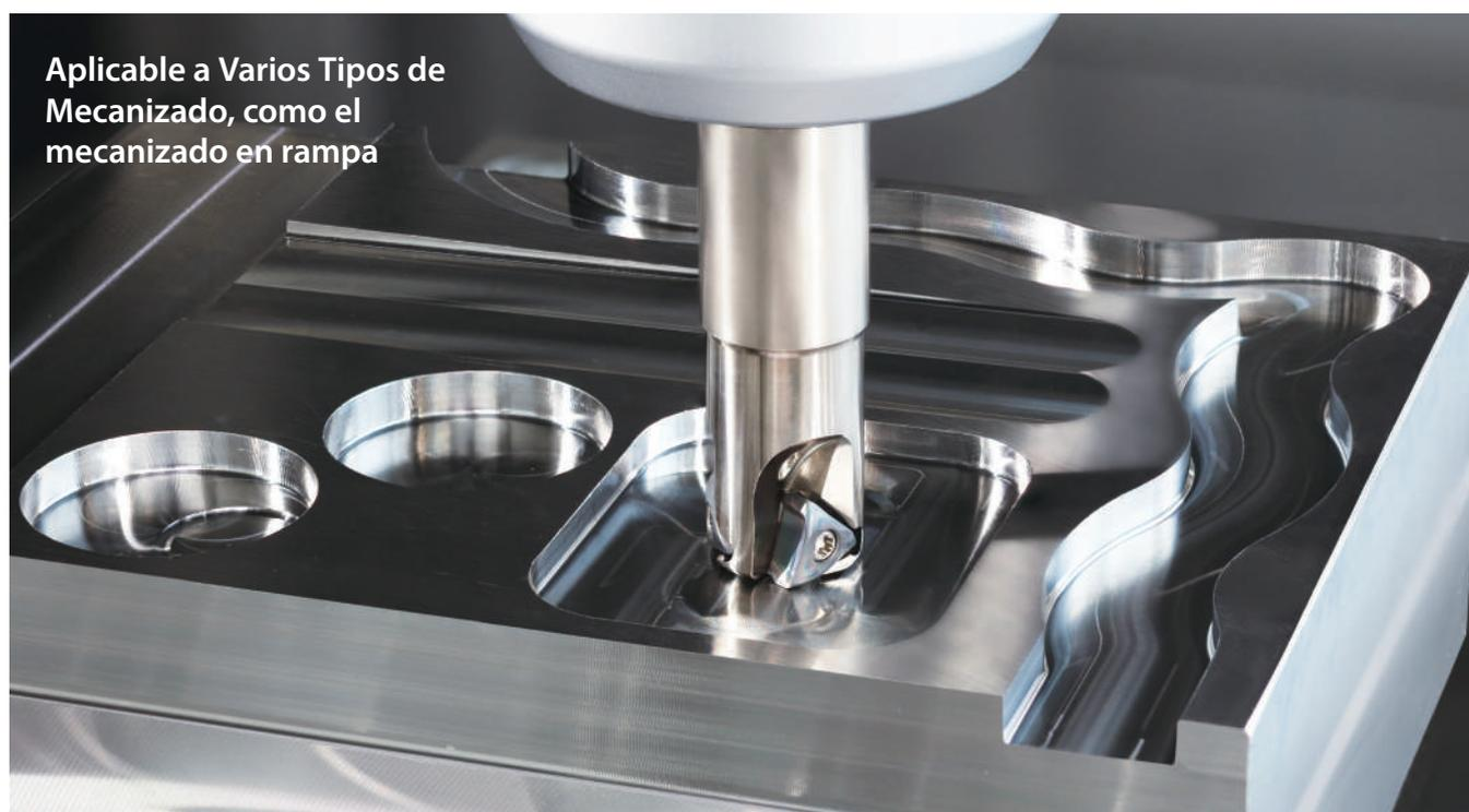
Aplicable a Varios Tipos de Mecanizado, como el mecanizado en rampa
