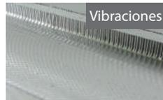
Condiciones de corte :  $V_c = 220$  m/min,  $ap = 3$  mm (Ranurado),  $f_z = 0.10$  mm/t,  $\phi 20$  (3 insertos), Sin Refr.
