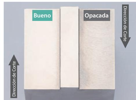
Condiciones de corte :  $V_c = 180$  m/min,  $ap \times ae = 3 \times 40$  mm,  $f_z = 0.1$  mm/t,  $\phi 50$  (5 insertos), Sin Refr. Pieza de Trabajo : S50C
