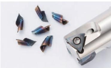
Condiciones de corte:  $V_c = 150$  m/min,  $a_p = 6$  mm (Ranurado)  $f_z = 0.2$  mm/t,  $\phi 20$  (3 inserto), Sin Refr. Pieza de Trabajo: SS400
